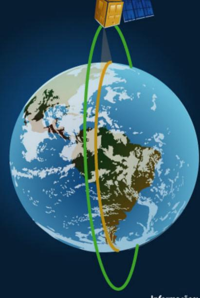
Informações: Altura da órbita: 628,6 km Inclinação: 97.890 graus Duração de cada órbita: 97,25 min Órbita por dia: 14,8
